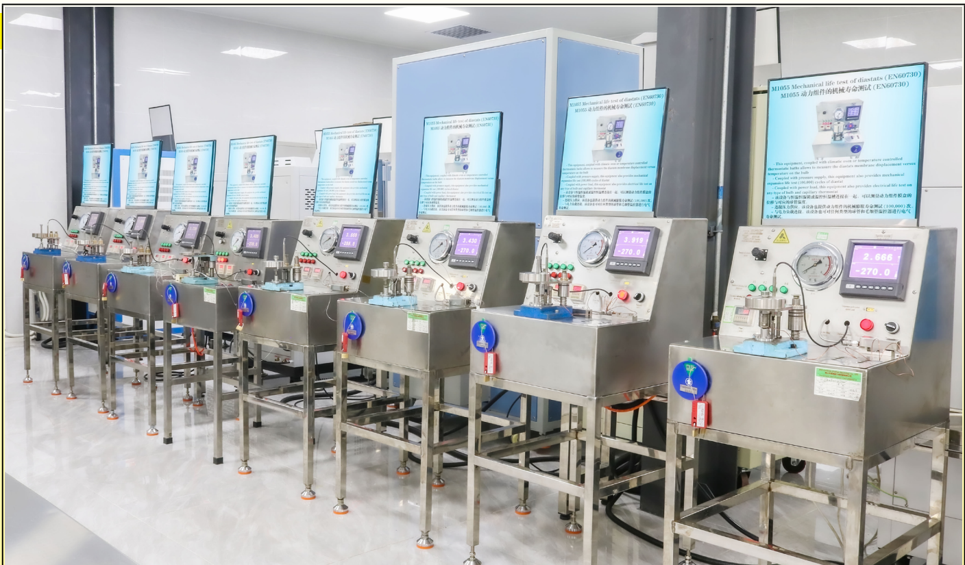
Un set di apparecchiature automatiche per test di durata meccanica diastat. Ogni apparecchiatura ha un registratore dati dei parametri di test e del numero di cicli (Laboratorio Ultimheat).
